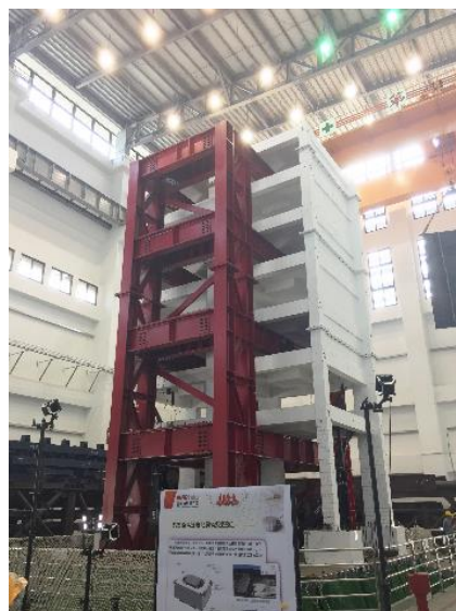
実験体を振動台にセットした様子
