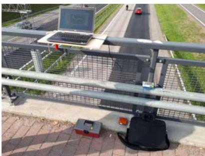
図-1 橋梁側加速度センサー
