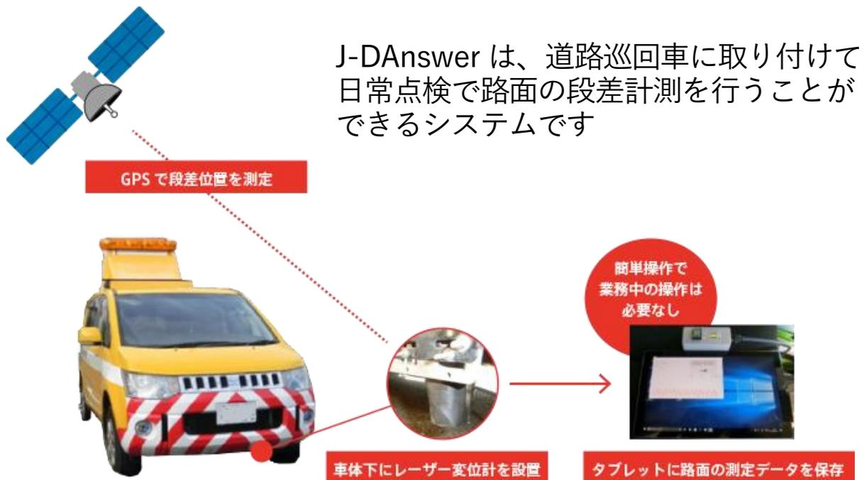
今後のインフラメンテナンスにおいては、効率的かつ経済的な予防・予知保全が重要となります。当社では、効率性や経済性の観点から、管理対象の構造物にセンサー類を固定するのではなく、車両に計測装置を搭載して対象の構造物を通過する際の計測データから状態を診断する車載型センシングシステムの開発を続けております。また、計測データを分析し、外からは見えない構造物の状態変化の予兆を捉える技術も開発しております。これまでも車載型センシングシステムを活用して、路線バスを利用した道路や橋梁の変状モニタリング実証実験や、地
