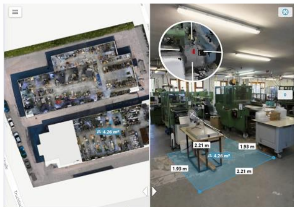
▲NavVisで測定した工場内の3Dデータ
